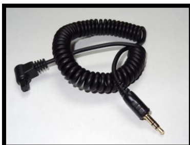
Un cordon permettant de se relier à l'entrée "shutter release" de l'appareil photo.
